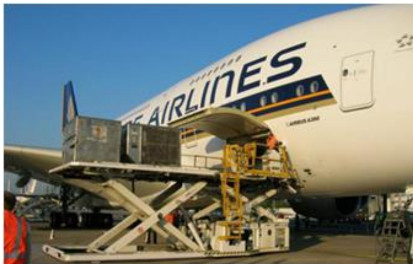
FIGURA.53 Operador ingresando ULD a la aeronave desde el cargo loader
