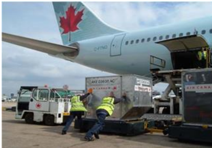
FIGURA.90 Esfuerzo de operadores de GRH para pasar ULD del Dollie al Cargo Loader
