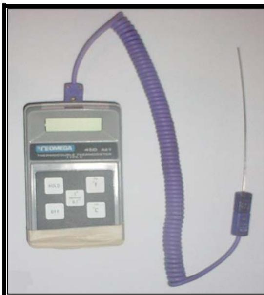
**Figura 2.10: Medidor de la temperatura ambiente**
