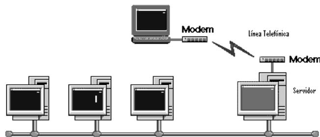
**FIGURA 1.2** Conexión mediante vía telefónica y MODEM.
