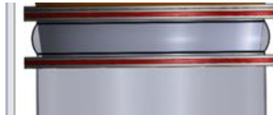
FIGURA 2.24 DISEÑO DE JUNTA DE EXPANSION DE 1700 MM
