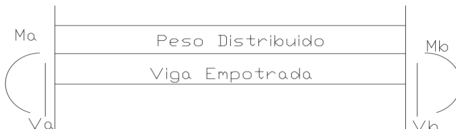
FIGURA 2.20 MODELO DE LA CARGA EN LA VIGA
