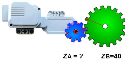
Figura 2. Sistema de engranajes para motor EV3
