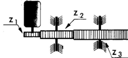
3. Un tren de engranajes compuesto está accionado por un motor que gira a 3000 r.p.m. Sabiendo que las ruedas 1 y 2 tienen 15 y 30 dientes, y que las ruedas 3 y 4 tienen 20 y 80 dientes respectivamente, calcula la velocidad con que gira cada rueda y la relación de transmisión total del tren de engranajes. (4 puntos)
