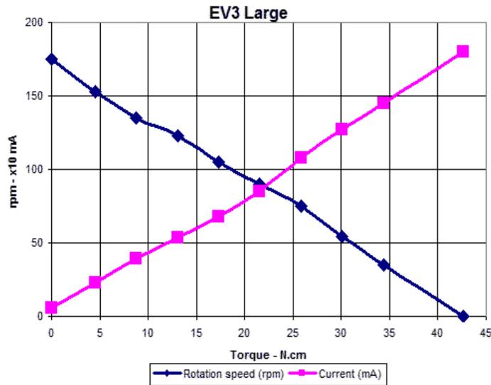
Figura 1. Curvas velocidad – torque de Motor EV3
