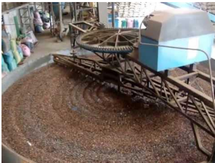
Figura 1.2: Foto de proceso de secado de Cacao artificial. [3]
