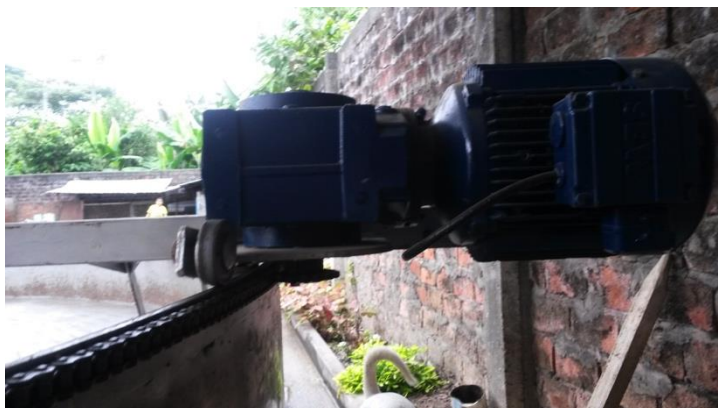
Figura 1.4: Motor que moviliza las aspas.
