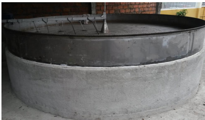
Figura 1.3: Recamara de calor y plato de acero de secadora.
