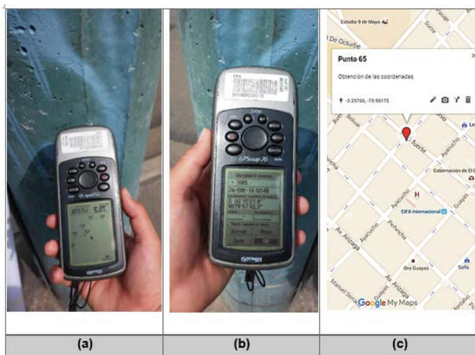
Figura 3.24: Toma de datos de la posición geográfica del poste, (a) su ubicación en el GPS, (b) Guardando un Waypoint (numero 65) en la memoria del GPS, y (c) ubicación referenciada del punto 65 en el mapa.
