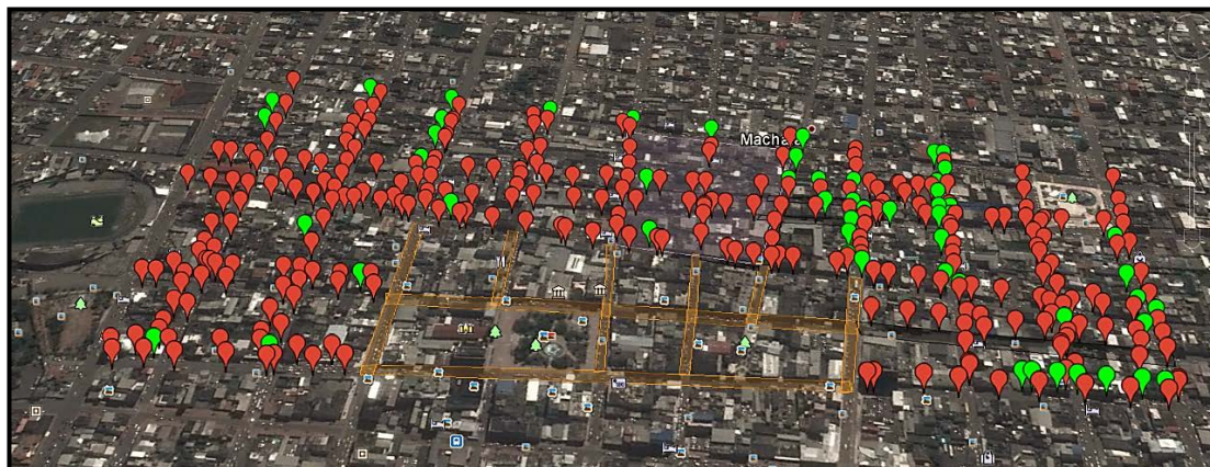
Figura 3.35: Distribución de los postes en el sector, utilizados para el tendido del cableado aéreo de las redes de telecomunicaciones.
