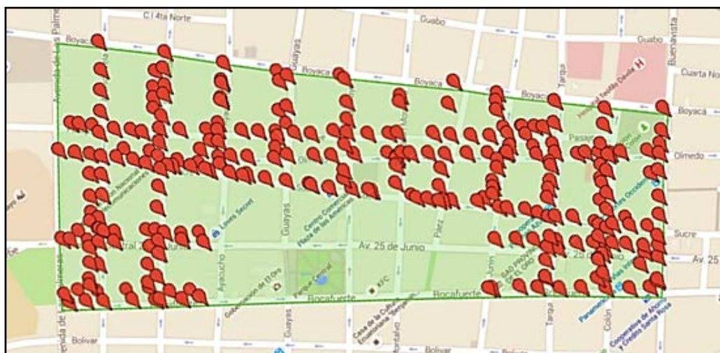
Figura 3.30: Georreferenciación de la distribución de datos obtenidos por el GPS de la ubicación de los postes de propiedad de la CNEL.
