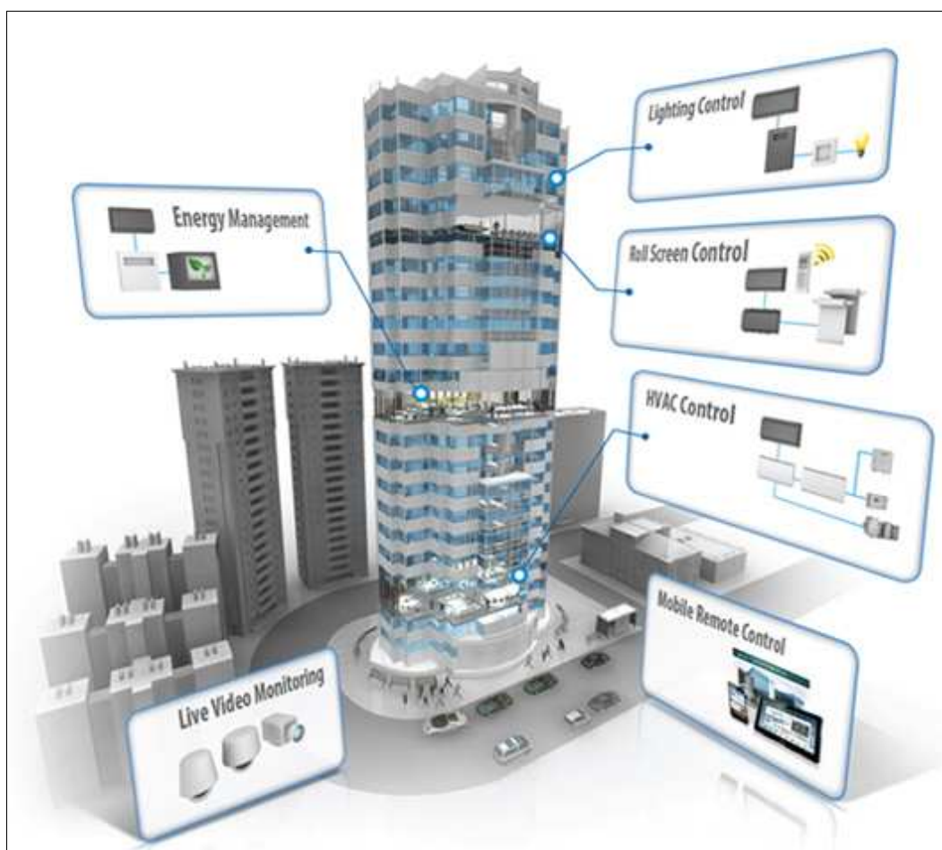
Figura 1.9: Control y monitoreo en edificio inteligente típico.
