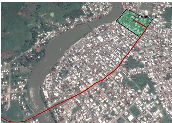
Figura 3.10 Llegada de la fibra óptica hacia el nodo central
