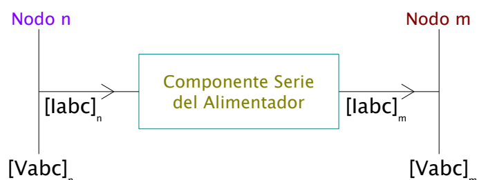
Figura 3.1: Modelo estándar de componentes serie de un alimentador [1].
