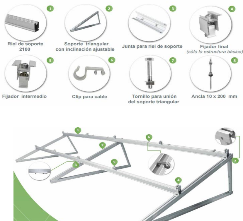
Figura 3.17: Estructura de Soporte [26].
