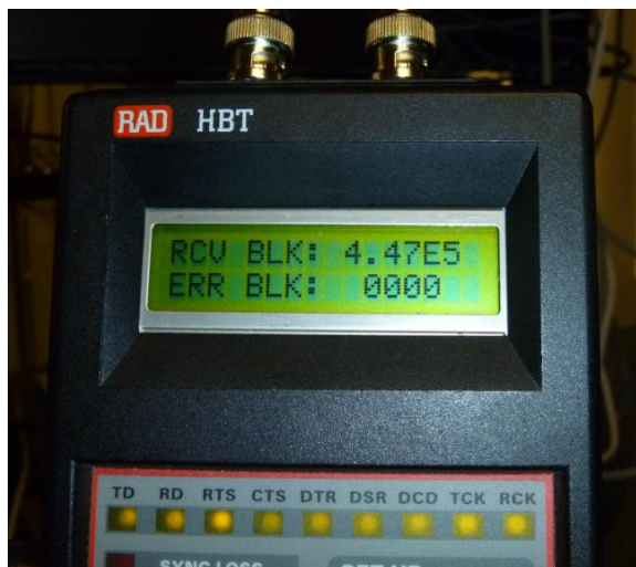
Figura 3.74 Toma de errores con el Analizador (HBT)
