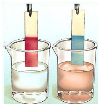
Figura 1-1 Papel Tornasol como indicador de pH
