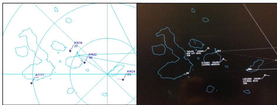
Figura 5. 6: Comparación del posicionamiento de una aeronave en vuelo con la señal del radar de Galápagos
