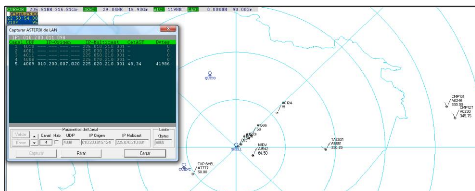
Figura 4. 30: Captura de datos y presentación de tracks del radar de Shell.
