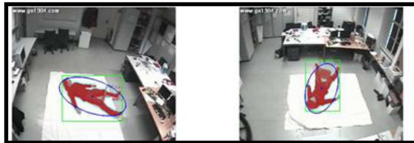
Figura 2.2: El empleo de cámaras detecta la postura a través de la medición de los ejes de la elipse que envuelve a la persona caída. También es posible la medición de velocidad de movimientos mediante la variación de píxeles en un frame (Fuente: Cogvis 2010)
