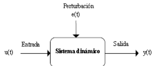
Fig. 2.18. Sistema dinámico con entrada u(t) , perturbación e(t) y salida y(t) [12]
