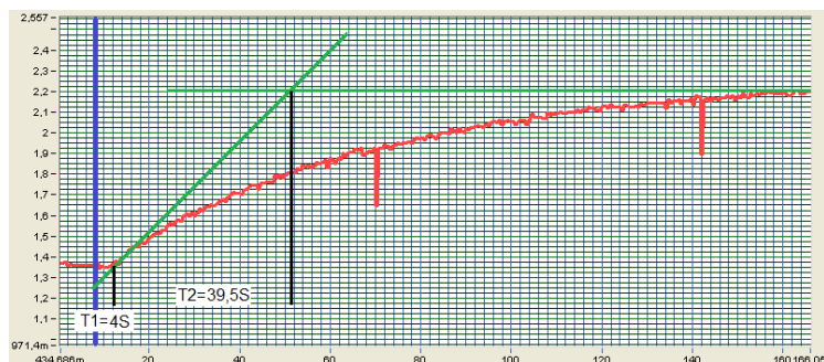
Fig. 5.9. Curva de respuesta y obtención de tiempos para Z & N.
