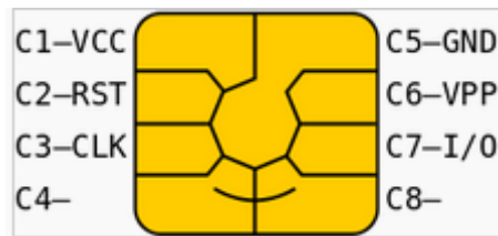
Figura 2.2: Contactos del chip de una tarjeta con contactos
