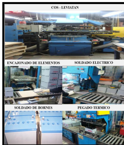
Ilustración 10: Montaje de Baterías
