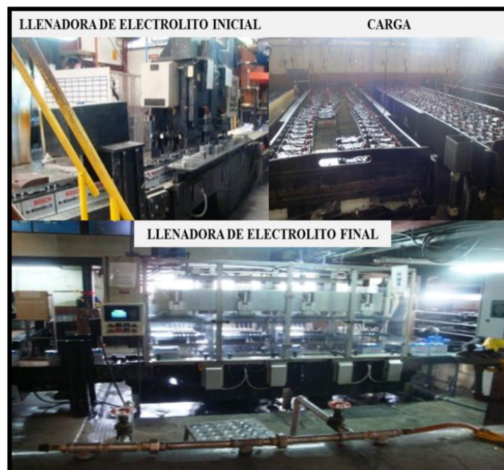
Ilustración 11: Carga de las Baterías
