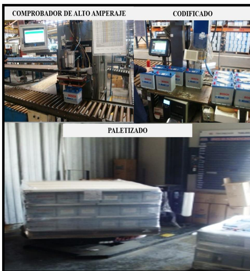
Ilustración 12: Despacho de Baterías
