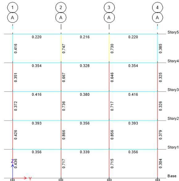
Figura 4.78. Verificación de secciones en el modelo ETABS, alternativa 3.
