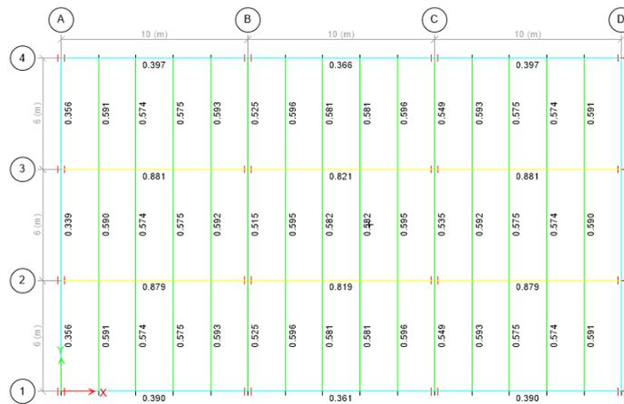
Figura 4.79. Verificación de secciones en el modelo ETABS, alternativa 3.
