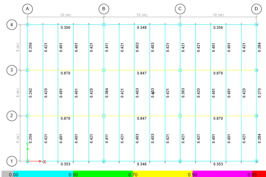
**Figura 4.64.** Verificación de las secciones vista en planta en el modelo ETABS, alternativa 2
