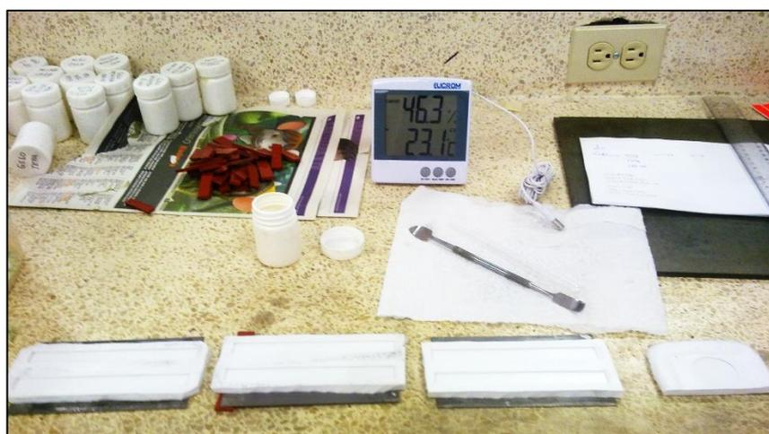
**FIGURA 3.85. MOLDES DE SILICÓN PARA EL CURADO DE PROBETAS**
