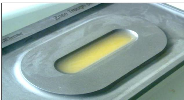
**FIGURA 2.24. PORTAMUESTRA DE LÍQUIDOS PARA ESPECTROMETRÍA MID-IR EN EL FTIR**
