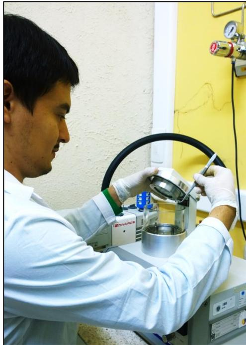
**FIGURA 3.90. COLOCACIÓN DE PORTAMUESTRA EN RECUBRIDOR METÁLICO DE PLATINO**
