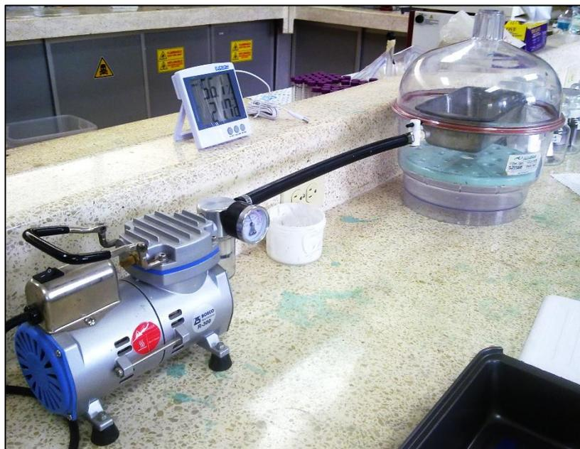
**FIGURA 3.84. COLOCACIÓN DE MOLDE PARA SILICÓN EN CÁMARA DE VACÍO PARA EXTRACCIÓN DE AIRE**
