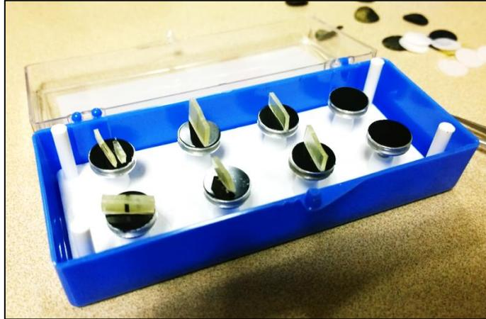
**FIGURA 3.89. PROBETAS CORTADAS COLOCADAS EN PORTAMUESTRAS PARA RECUBRIDOR**
