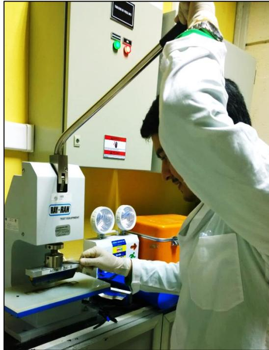
**FIGURA 3.82. TROQUELADOR PARA PLATILLAS
