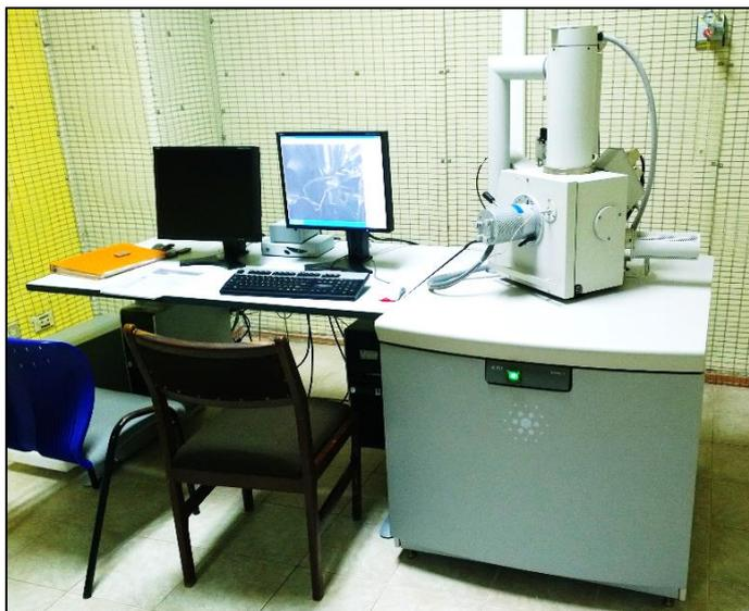
**FIGURA 3.60. MICROSCOPIO DE BARRIDO ELECTRÓNICO**
