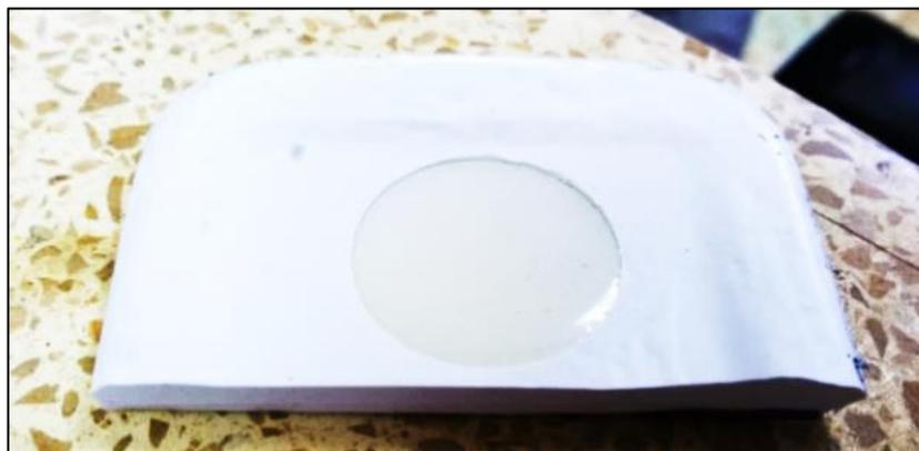
**FIGURA 3.69. MEZCLA VERTIDA EN MOLDE DE SILICÓN PARA EL CURADO DE DISCO**
