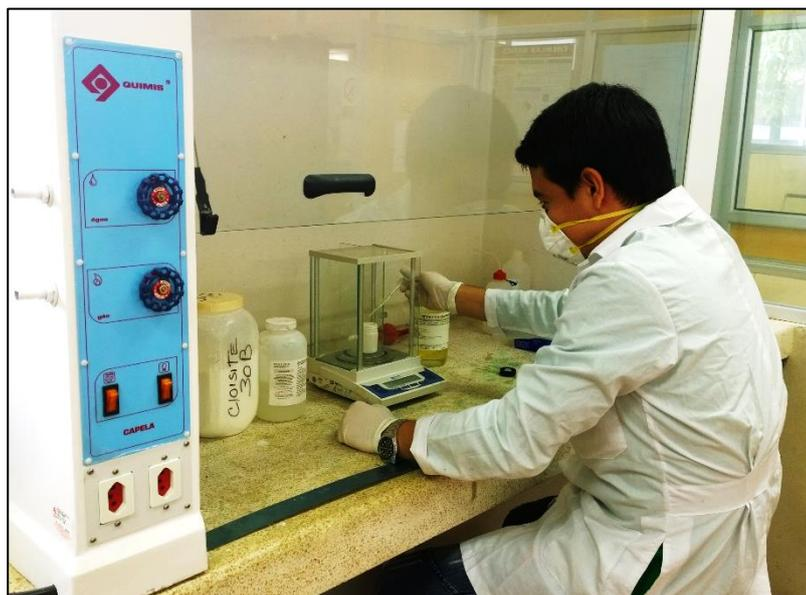
**FIGURA 3.72. PESAJE DE RESINA, AMINA, ARCILLA E INHIBIDOR DE CORROSIÓN**
