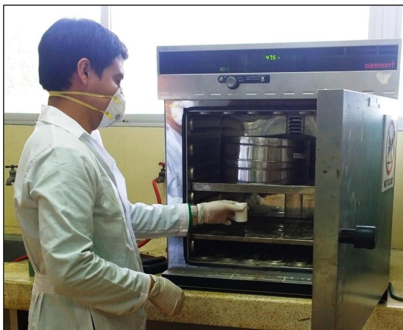
**FIGURA 3.74. COLOCACIÓN DE ENVASE DE MEZCLADO CON INHIBIDOR Y ARCILLA EN HORNO ELÉCTRICO**
