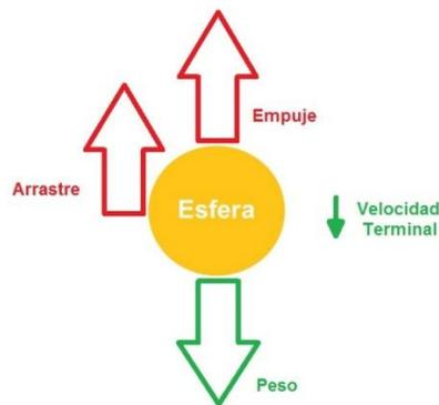
Del diagrama de fuerzas actuando sobre la partícula esférica de arcilla junto con el concepto de velocidad terminal, se obtiene la primera ecuación, en donde:
