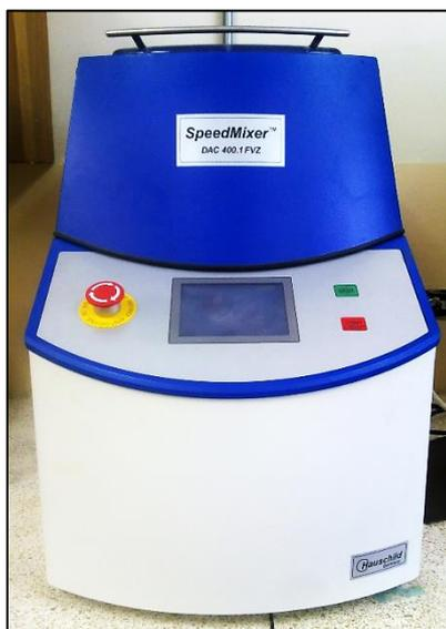
**FIGURA 3.48. MEZCLADOR CENTRÍFUGO**
