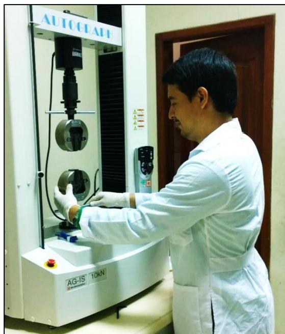
**FIGURA 3.87. COLOCACIÓN DE PROBETA EN MÁQUINA
