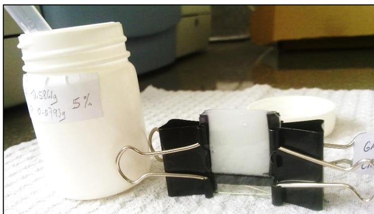
**FIGURA 3.77. VERTIDO DE MEZCLA EN PORTAMUESTRA DE CURADO**
