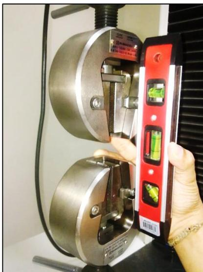
**FIGURA 2.27. ALINEACIÓN DE MANDRILES DE SUJECCIÓN
