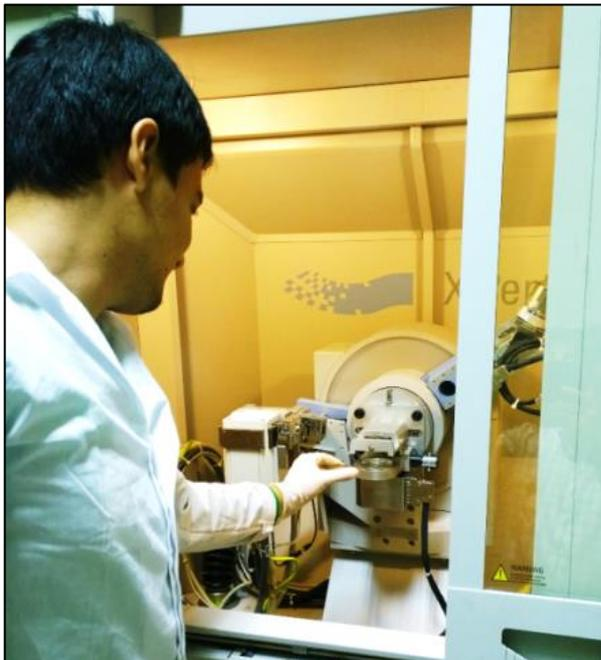
**FIGURA 3.71. COLOCACIÓN DE PORTAMUESTRA EN EL DIFRACTOMETRO DE RAYOS X**
