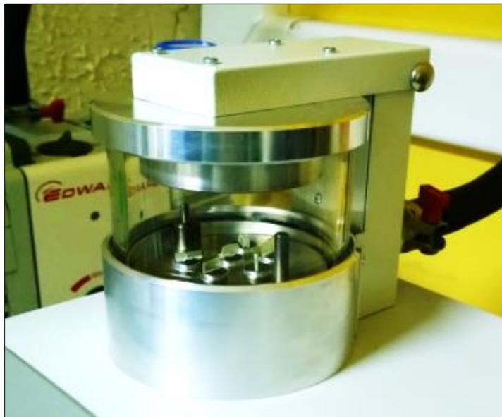
**FIGURA 2.28. PORTAMUESTRAS DENTRO DE RECUBRIDOR METÁLICO DE PLATINO**
