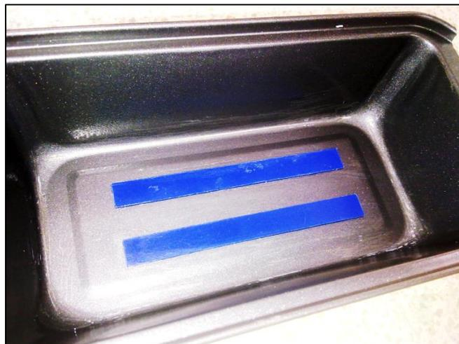
**FIGURA 3.83 MOLDE PARA SILICÓN CON PLANTILLAS
