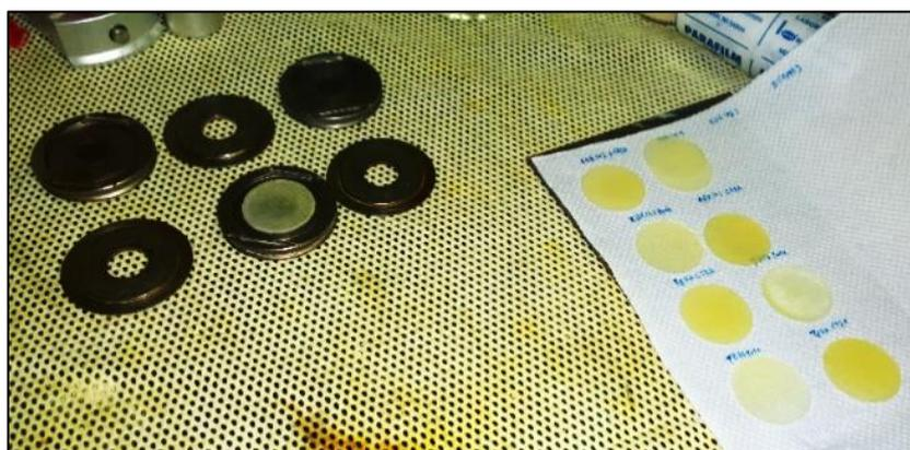
**FIGURA 3.70. DISCOS CURADOS JUNTO A LOS PORTAMUESTRAS DEL XRD**
