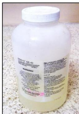
**FIGURA 3.12. RESINA EPÓXICA GE-40**
