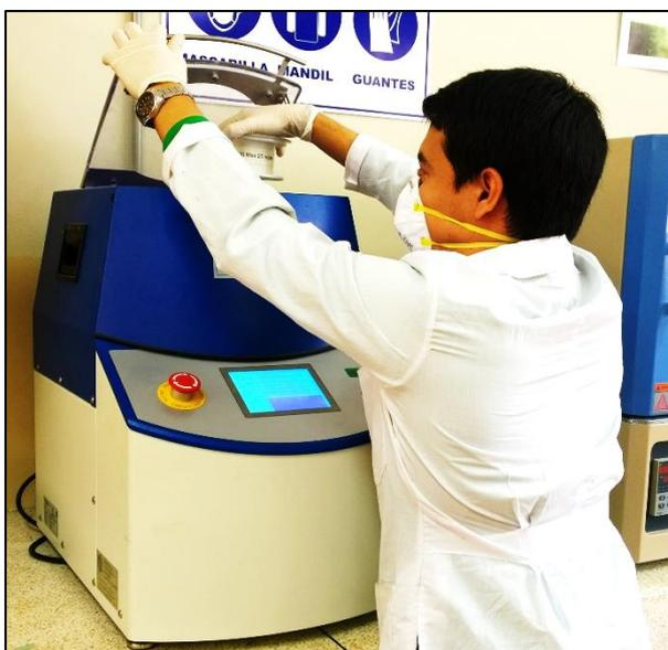
**FIGURA 3.66. COLOCACIÓN DE HOLDER CON MUESTRA EN
