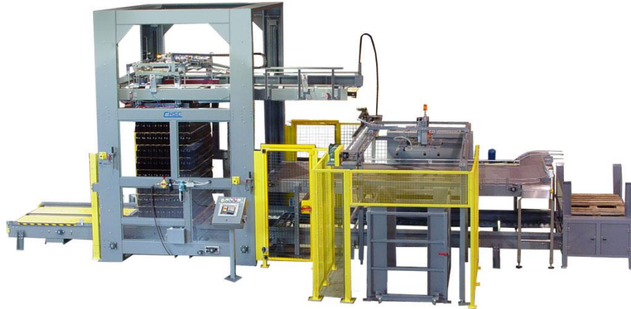
Figura 1.4. Despaletizadora a granel con descarga a nivel bajo
