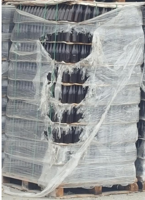
Figura 1.2 Bulto de botellas de vidrio al granel, dañado por factores externos
