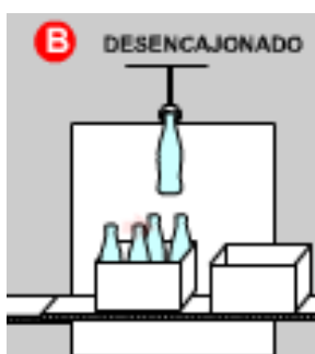
Figura 9. Representación del funcionamiento de la Desencajonadora
