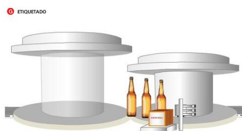
Figura 14. Representación del funcionamiento de la Etiquetadora
