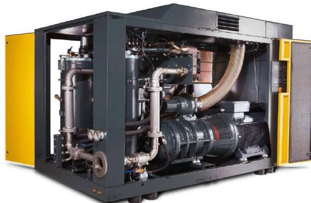
**FIGURA 2.8. COMPRESOR DE TORNILLO**
