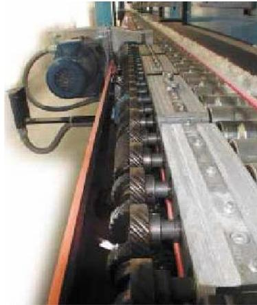
**FIGURA 2.4.** SISTEMA DE MOVIMIENTO HORNO DE RODILLOS
