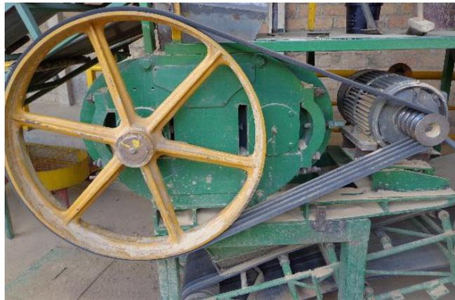
**FIGURA 2.2. MOLINO DE RODILLOS**
