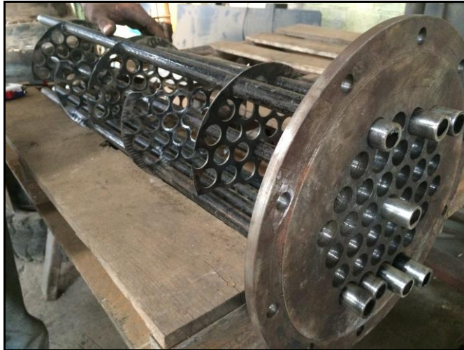
Figura 2.5 Vista interior de intercambiador de calor durante su construcción.
