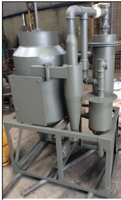
Figura 3.1 Planta piloto de gasificación.
