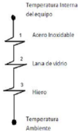
Figura 2.4. Circuito térmico del sistema
