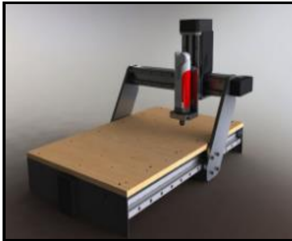
Figura 2.2 Alternativa dos: Máquina fresadora CNC- Router
