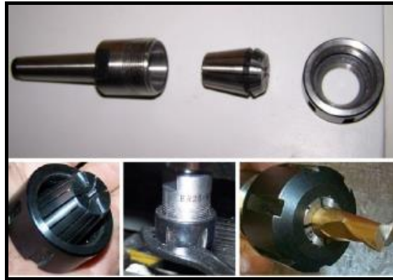
Figura 2.6 Sistema de intercambio manual de la Herramienta de Corte
