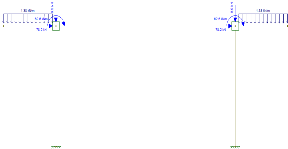
Figura 2.11: Cargas que soporta la estructura
