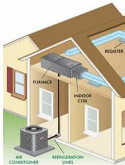
Figura 9: Sistema de Expansión Directa
