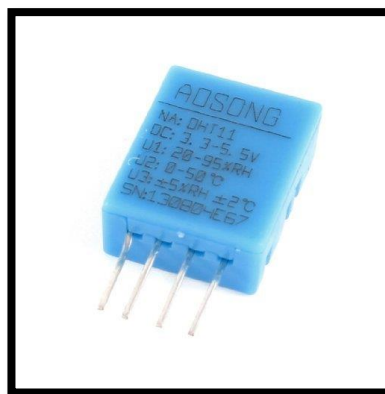
Figura 3.8: Sensor de humedad relativa y temperatura DHT11
