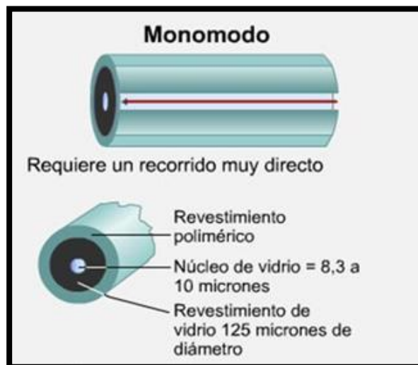
Figura 2.2: Fibra Óptica Monomodo [11].
