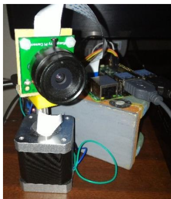
Figura 3.9 Integración del motor de pasos con la Pi Camera
