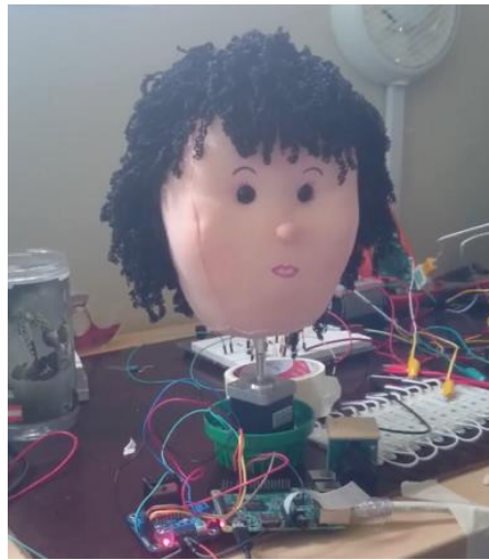
Figura 3.11 Acoplamiento de la cabeza del muñeco con el brazo del motor de pasos.
