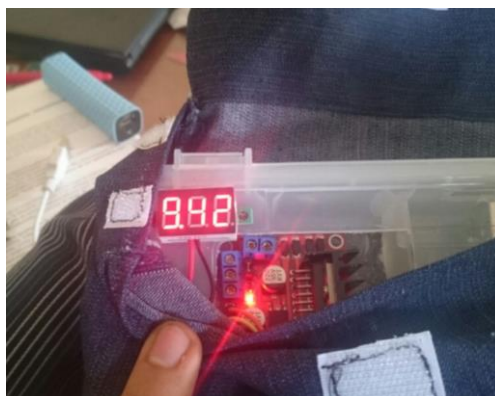
Figura 2.4 Voltímetro que monitorea el voltaje que llega al motor
