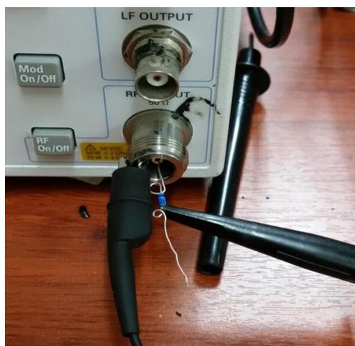
**Figura 3.12: Ensayo de pérdidas en el diodo.**
