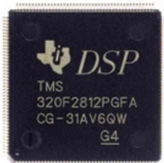
**Figura 2.1 Procesador Digital de Señal TMS320F2812 [2]**
