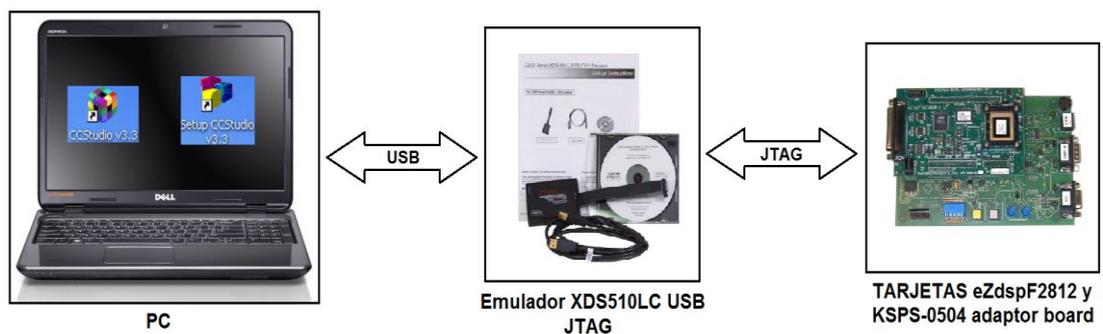
**Figura 2.15 Conexiones entre Hardware y Software**
