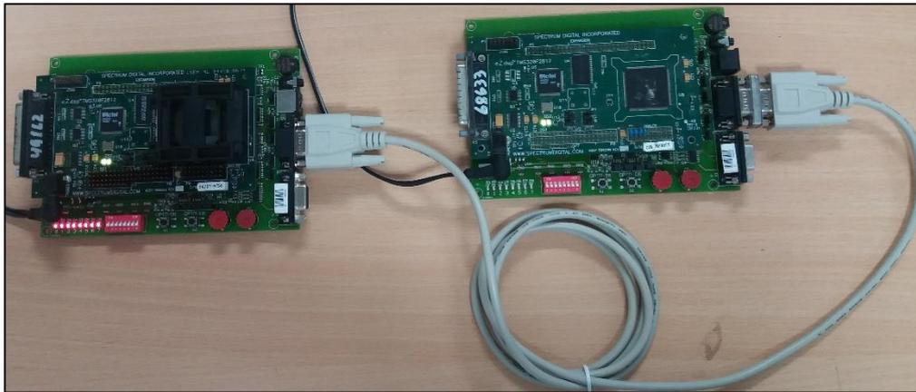
**Figura 4.151 Ejecución de la práctica sobre comunicación CAN**
