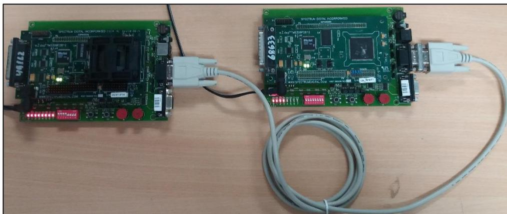
**Figura 4.152 Demostración de la práctica sobre comunicación CAN**
