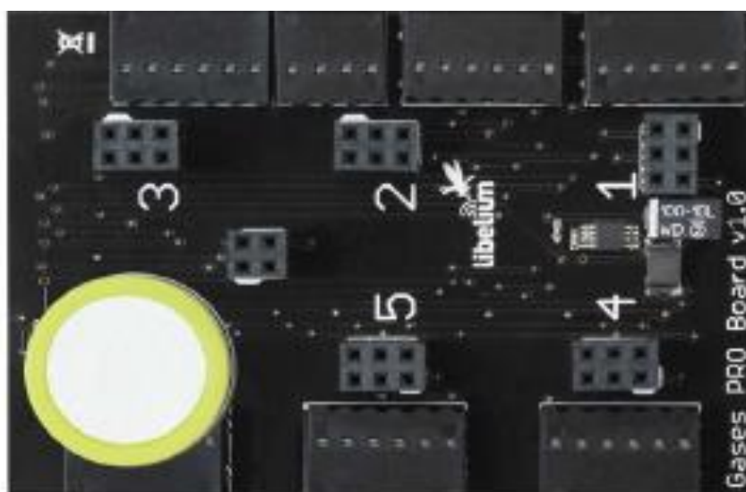
Figura 3.18 Sensor CO incorporado en el módulo [4]
