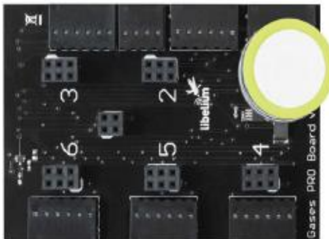
Figura 3.20 Sensor CO2 incorporado en el módulo [4]
