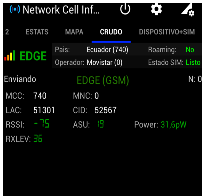
Figura 3.32: Información sobre otros aspectos técnicos de la red celular de la operadora Movistar
