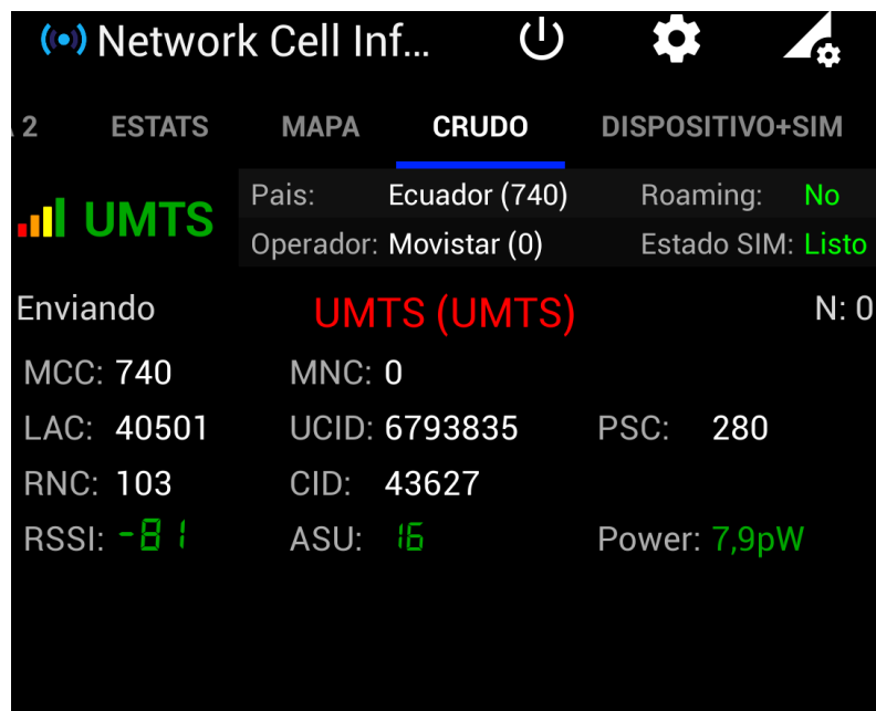
Figura 3.20: Información sobre otros aspectos técnicos de la red celular de la operadora Movistar
