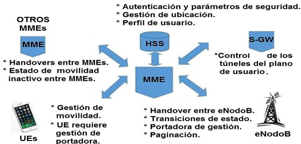
Figura 2.9. Conexiones de un MME y sus funciones [24].
