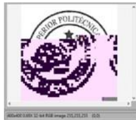
Figura. 29. Imagen Distorsionada Canal A Modulación 64QAM Codificación Hamming 7
