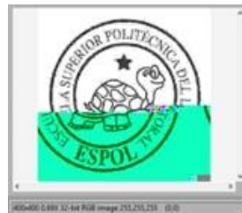
Figura. 30. Imagen Distorsionada Canal B Modulación QPSK Codificación LDPC 10-3
