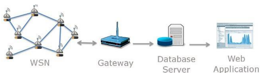
Figura 2.5 Elementos que conforman una WSN [48]
