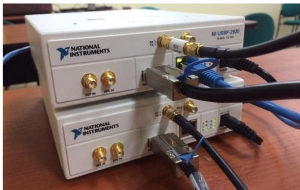
**Fig. 17.** Conexión física de NI USRP-2920.
