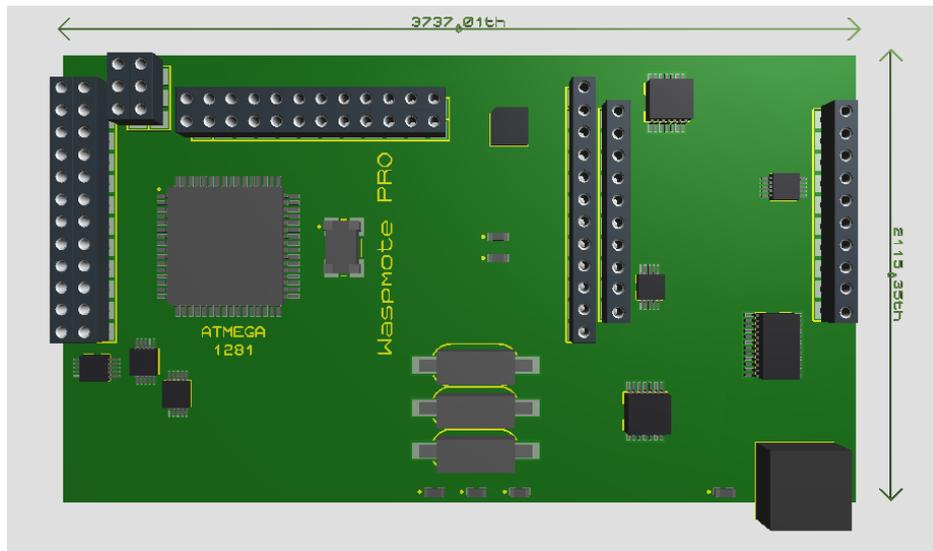
Figura 4.2: Vista Superior de la mote Wasp mote
