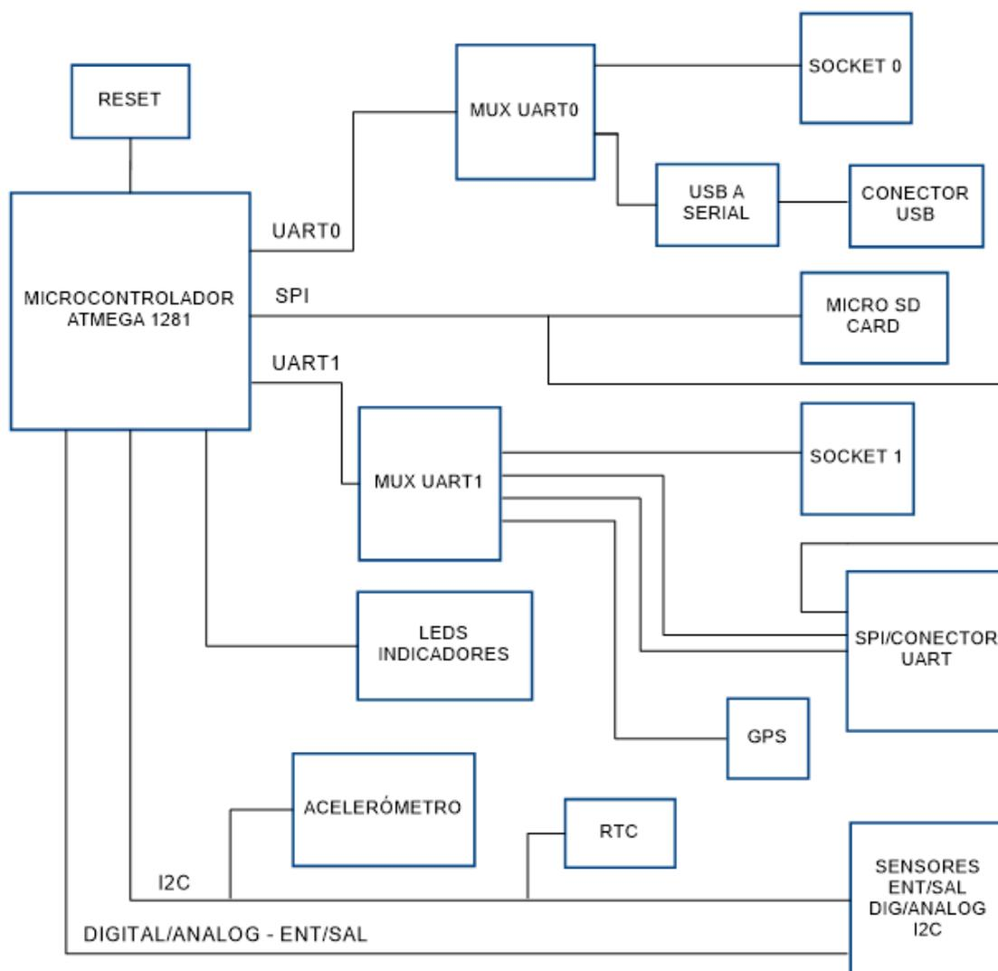
**Figura 4.3: Diagrama de bloques y señales de datos del Waspote [38].**
