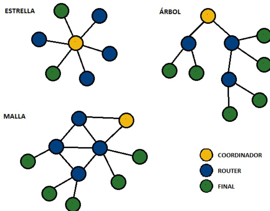
Figura 2.3: Tipos de topología de ZigBee [31].
