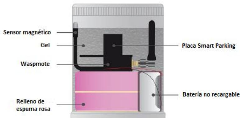
**Figura 4.6: Diagrama interno de un nodo de estacionamiento [39].**
