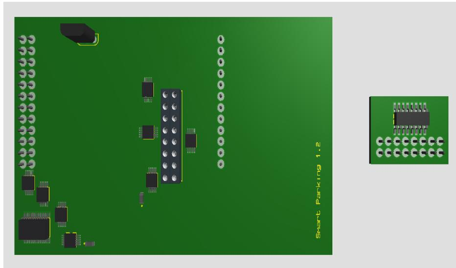
**Figura 4.4: Vista Superior de placa Smart Parking y sensor magnético.**
