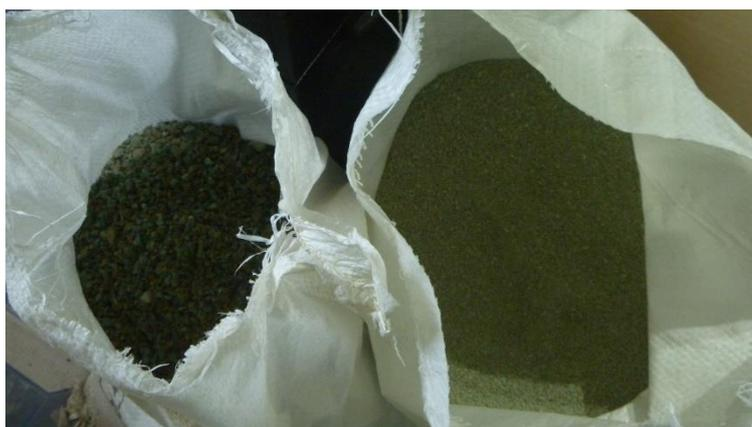
**Figura 2.5: Zeolita utilizada grado 16 y grado 6.**
