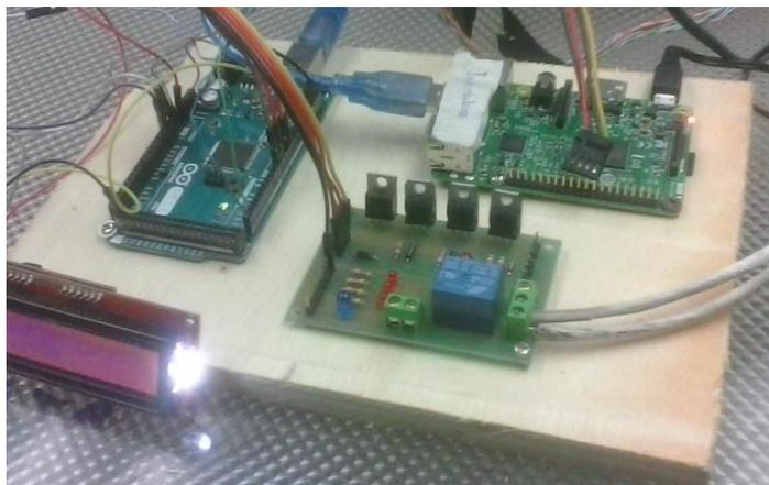
**Figura 3.3: Sistema electrónico para control de actuadores.**
