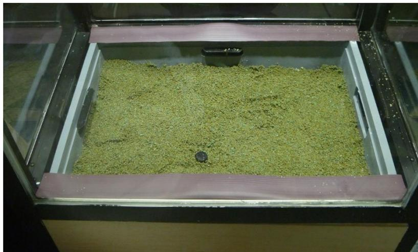
**Figura 2.8: Zeolita grado 6 en capa superior.**
