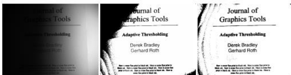
Figura 3.2. Resultado de la imagen utilizando umbral adaptativo propuesto por Bradley y Roth. Izquierda: captura inicial. Centro: técnica previa a la binarización. Derecha: Umbral Adaptativo Propuesto. [9]
