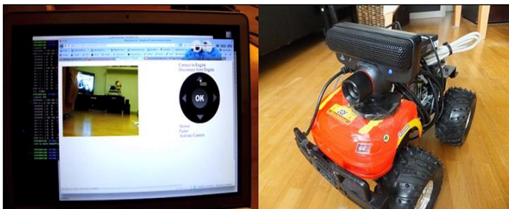
Figura 1.5: Robot controlado mediante una interface web.
