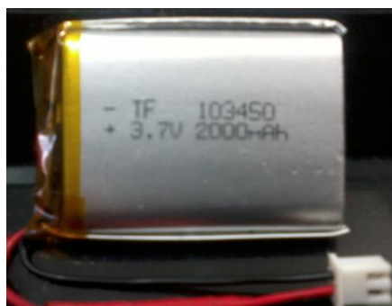
Figura 2.6: Batería de Litio Polímero, de 3.7V y 2000mAh, utilizada para energizar cada uno de los elementos electrónicos del dispositivo.
