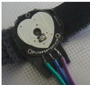
Figura 2.1: Sensor de pulso cardíaco, “Pulse Sensor”, utilizado para realizar la lectura del ritmo cardíaco mediante un led y un fotosensor.
