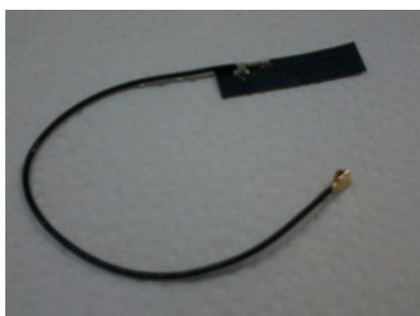
Figura 2.7: Antena GSM/GPRS con conector ufl, empleada para aumentar la intensidad en la señal de comunicación GPRS.
