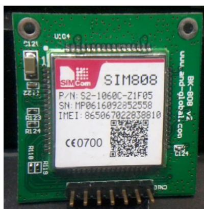
Figura 2.4: Módulo de comunicación Sim808, elaborado por la compañía SimCom, empleado para realizar el envío de datos del ritmo cardíaco, vía GPRS hacia la aplicación web.
