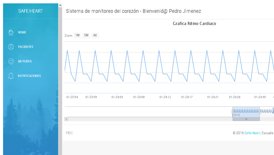
Figura 4.9: Página en donde se visualiza la señal PPG (Fotopletismógrafo) en tiempo real.
