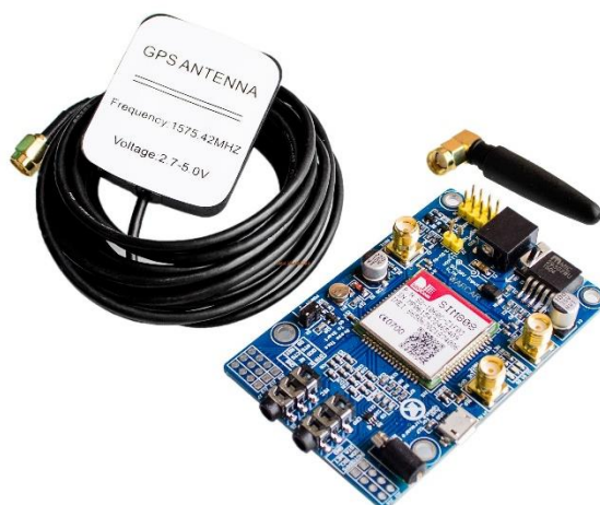
Figura 2.2 Modulo SIM808 utilizada para la obtención de coordenadas y envío de datos al servidor [18]
