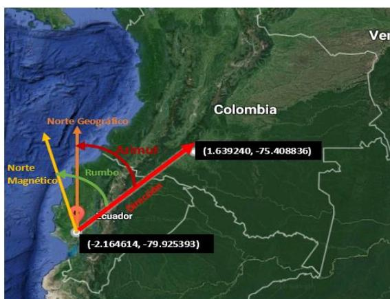
Figura 2.10 Ángulo de azimut entre 2 puntos geográficos.
