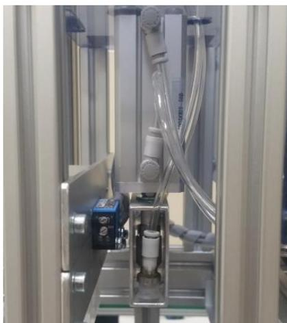
Figura 2.14: Cilindro de doble efecto.
