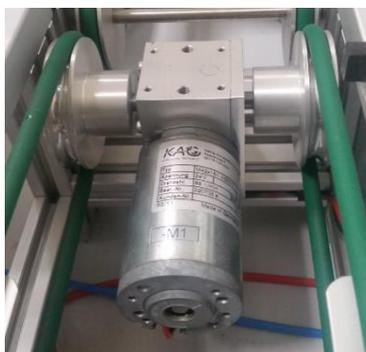
Figura 2.15: Motor reductor DC.
