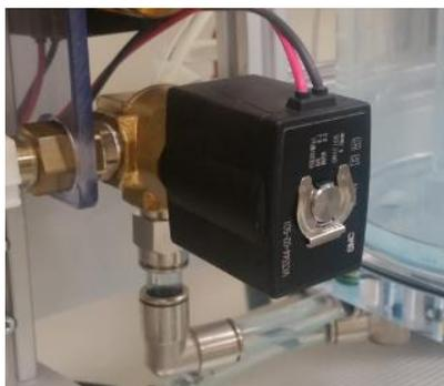
Figura 2.19: Válvula de distribución de 3/2 vías.
