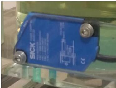
Figura 2.10: Sensor capacitivo.
