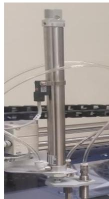
Figura 2.13: Cilindro de simple efecto.
