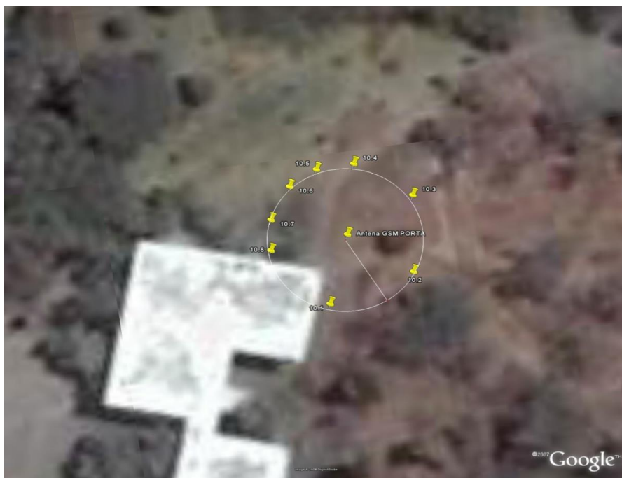
Figura 05.- Ejemplo de ubicación de puntos de medición alrededor de la antena.
