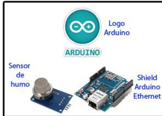
Figura 2.44: Sensor de humo, shield Arduino Ethernet y logo Arduino.
