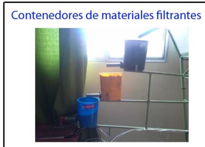
**Figura 2.12: Recipientes con el material filtrante a utilizar.**
