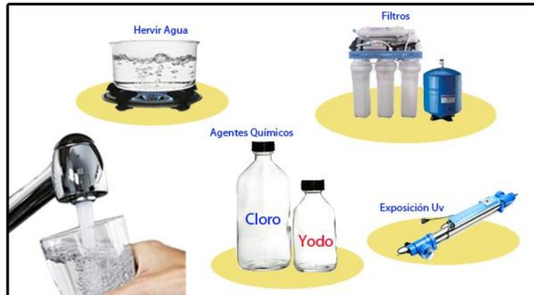
**Figura 2.2: Tipos de potabilización.**
