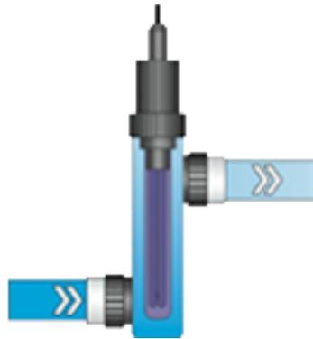
**Figura 2.13: Esquema de un sistema de radiación UV típico.**
