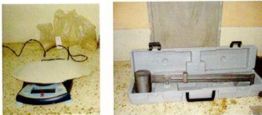
**Figura 2.2 Balanza electrónica y balanza de Baroid**
